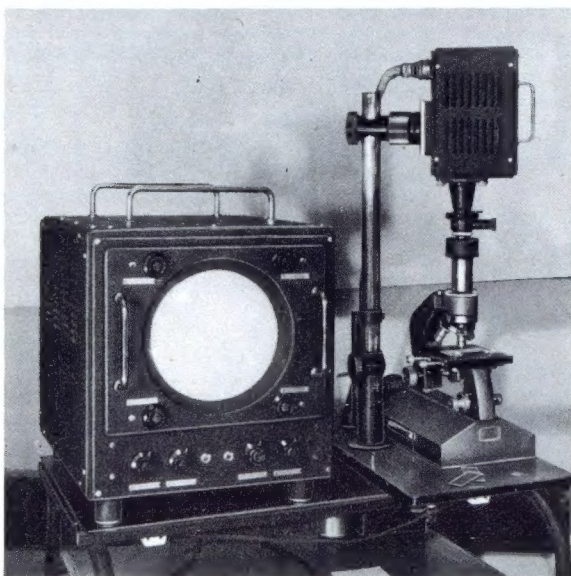
Rechts: Kamera mit Mikroskop; links: Monitor mit rundem Bild zur Übertragung von Mikroskopbildern
