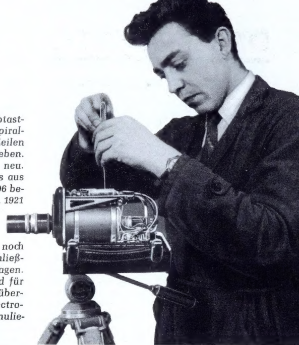
Die Aufnahmekamera für die Spiral-Abtastung. Die Kamera ist mit den Resistron, einer neuen Aufnahmeröhre, ausgerüstet
