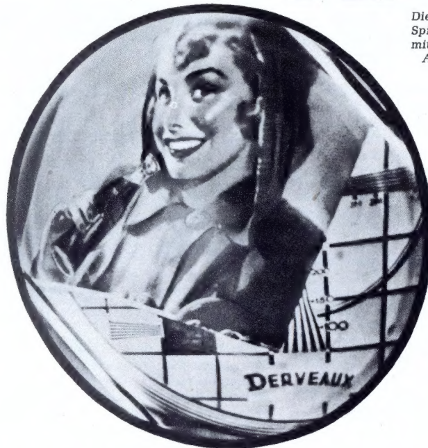
Links: Schirmbildaufnahme einer Fernseh-Übertragung mit Spiral-Abtastung, geschrieben mit 300 Spiralwindungen, die 600 Zeilen entsprechen
